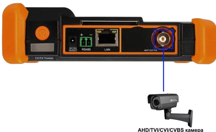
Рис. 10 Подключение AHD/TVI/CVI/CVBS видеокамеры к тестеру
