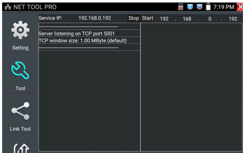
Рис. 90 Работа 1го тестера в режиме «сервер» при проверке пропускной способности сети
