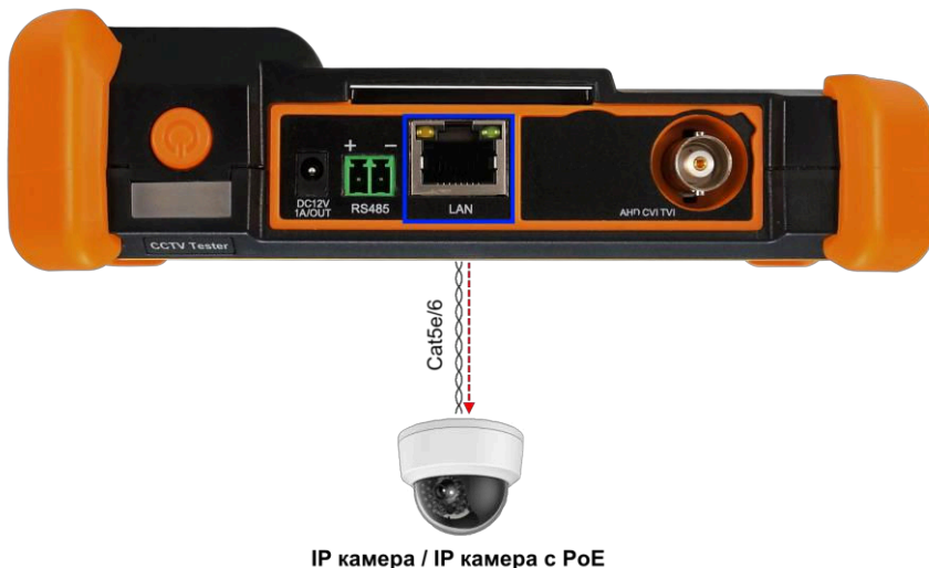
Рис. 7 Подключение IP-видеокамеры (в том числе с PoE питанием)
