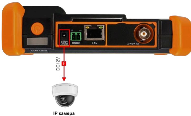
Рис. 9 Подключение питания к IP-видеокамере
