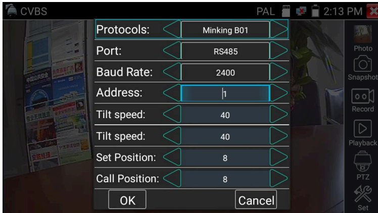
Рис. 61 Настройки PTZ для управления через RS-485
