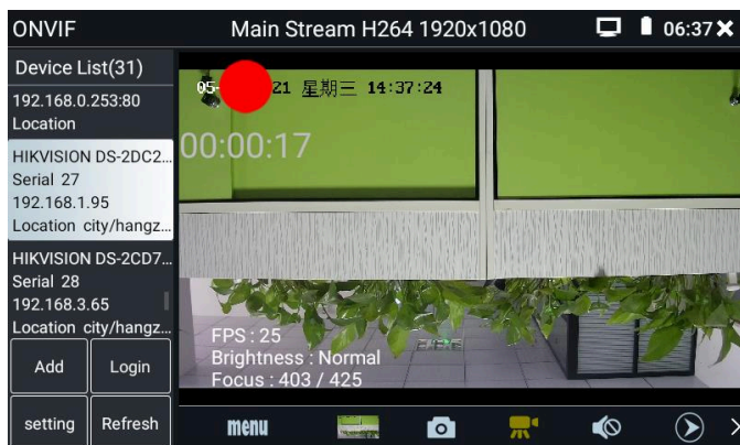
Рис. 45 Инструмент «запись видео» (Record)
