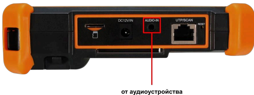
Рис. 12 Подключение тестера к аудиоустройствам
