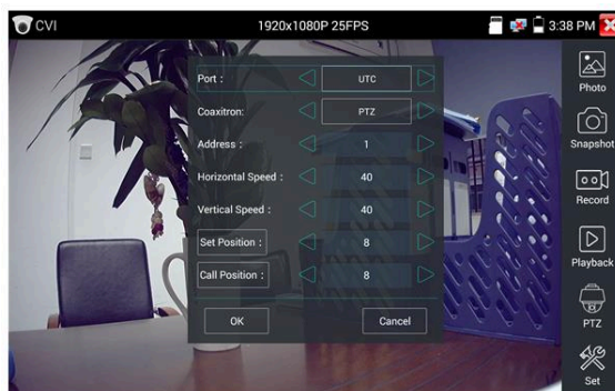
Рис. 74 Настройки для управления PTZ CVI видеокамерой по коаксиальному кабелю
