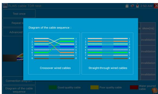
Рис. 103 Типы обжимки кабеля «витой пары»
