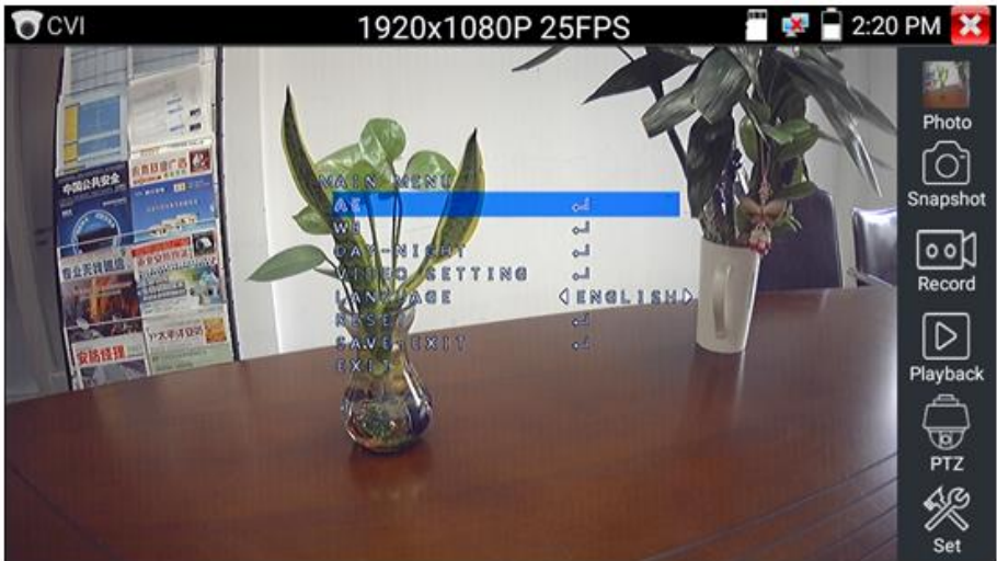
Рис. 79, 80 OSD меню PTZ CVI видеокамеры
