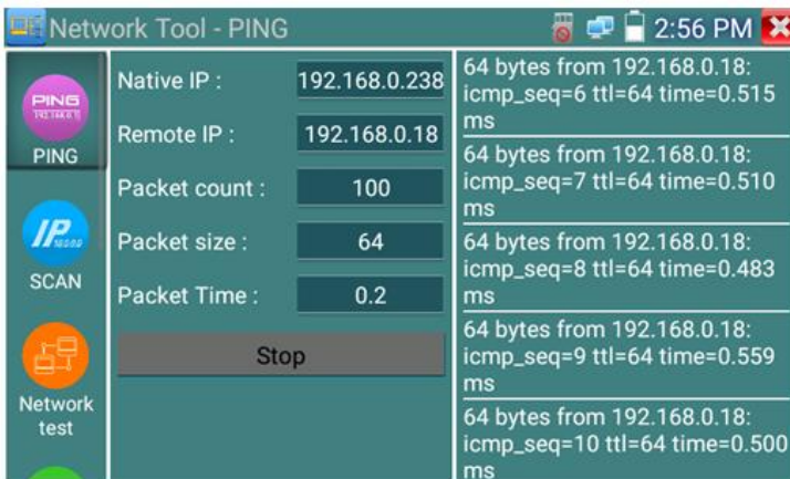
Рис. 86 Интерфейс инструмента «PING тест»
