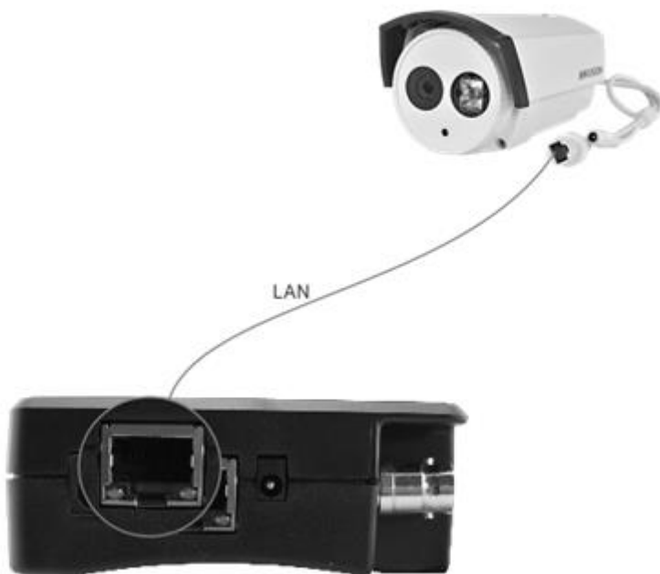
Рис. 8 Подключение IP-видеокамеры к тестеру
