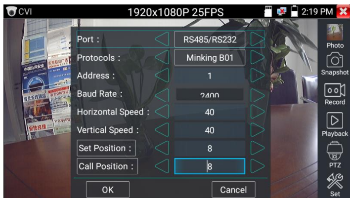
Рис.77 Управление PTZ CVI видеокamerой по интерфейсу RS232/485
