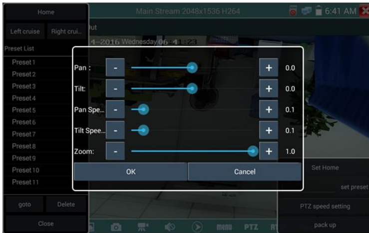
Рис. 50 Настройки горизонтальной и вертикальной скорости PTZ
