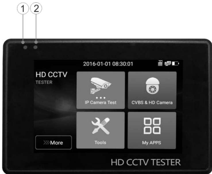
Рис. 3 TIP-H-4(Hand), индикаторы на передней панели
