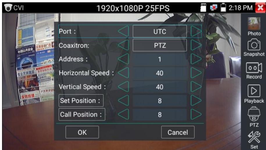
Рис.9 Настройки PTZ для видеокамер с UTC
