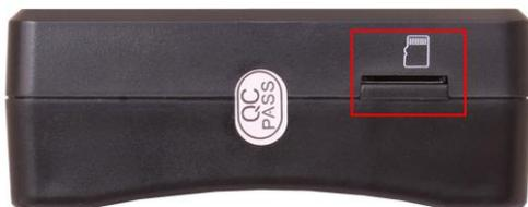
Рис. 24 Установка карты в Micro SD слот
