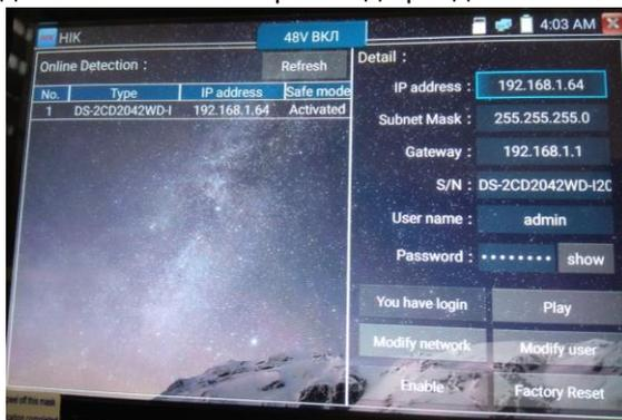
Рис. 23 Приложение HIK для теста IP-видеокамер производства HIKVISION
