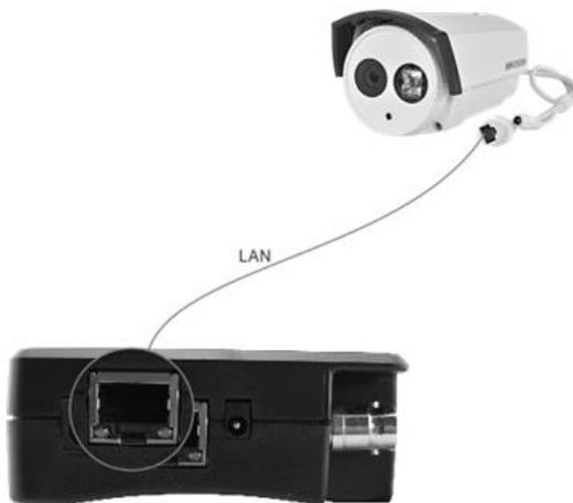
Рис. 10 Подключение ip-видеокамеры
