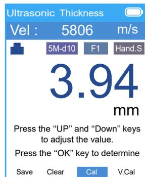
Измерьте толщину образца с точностью 0,01 мм. Кнопками **(UP)** и **(DOWN)** установите это значение. Далее нанесите тонкий слой контактного геля на поверхность датчика. Прижмите датчик к поверхности материала и нажмите кнопку **(OK)**. Прибор вычислит реальную скорость звука в исследуемом образце и её пересчитает.
