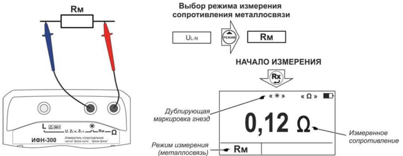
Рисунок 2.7 – Измерение сопротивления металlosвязи
