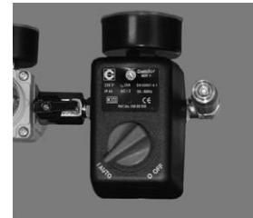
Компрессор начнет свою работу и будет автоматически выключаться по достижении нужного давления в ресивере. Как только по мере расхода воздуха давление в ресивере упадет до определенного уровня, двигатель компрессора включится и восполнит давление. Нормальный диапазон давлений – около 2 Бар.
