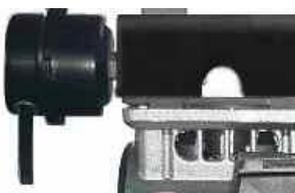
Установите воздушные фильтры, вкрутив их в головки цилиндров помпы компрессора, снимите перед этим защитный пластиковый колпачок.
