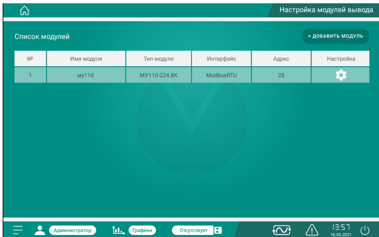
Рисунок 8.5 – Настройка модулей вывода
