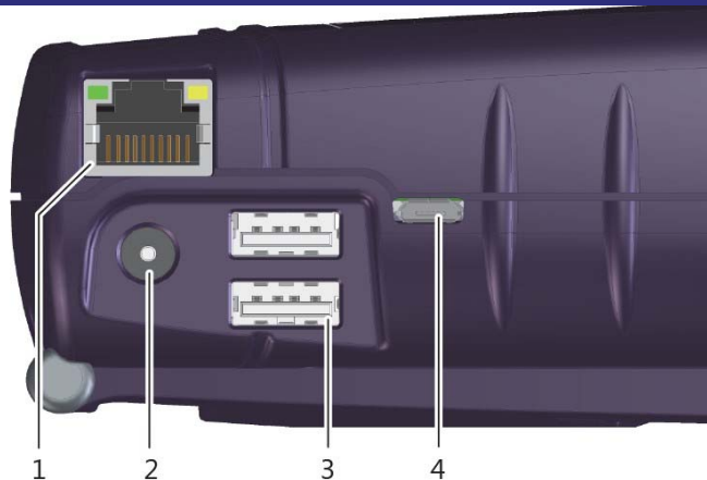
Рисунок 4. Внешний разъем питания и интерфейсы связи
