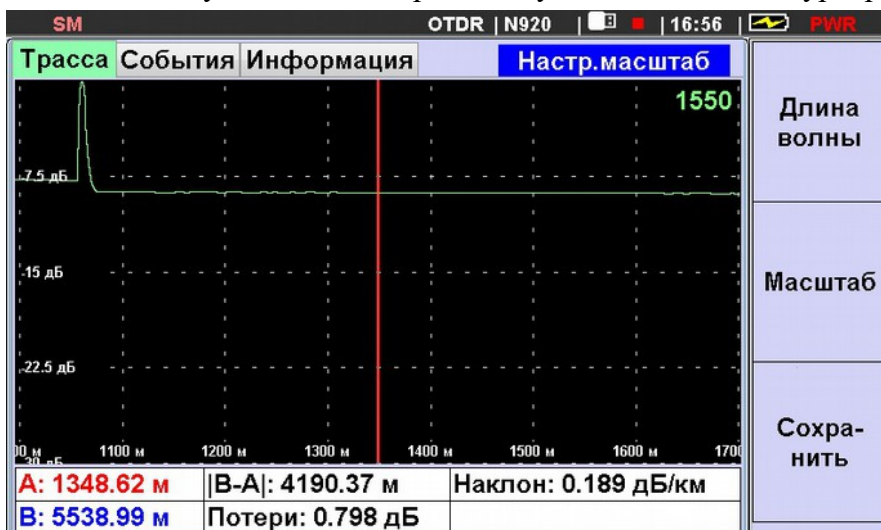
Рис. 5.15. Отображение участка рефлектограммы в режиме увеличения
