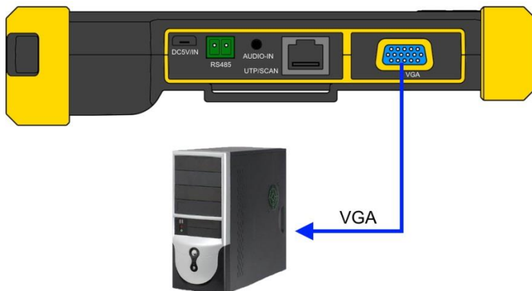
Рис. 14 Подключение устройств к VGA входу тестера
