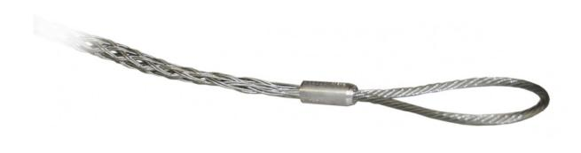
**Katimex 108004** — чулок для захвата кабеля диаметром 50-65 мм. Он обеспечивает надежный захват торца кабеля и удержание его при протяжке кабеля с усилием до 55,0 кН (5,6т), что обуславливается исполнением Katimex 108004 из прочного стального троса. При этом оптимальным для чулка является усилие затягивания равное **27,5кН (2,8т)**.
