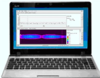
В рамках измерения Спектрограммы прибор выполняет измерение спектрограмм через каждую секунду.Результаты измерений сохраняются на флэшке с целью непосредственной передачи на РС на протяжении 72 часов.
