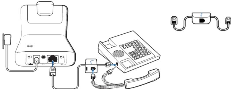
**Внимание.** Если в Вашем телефоне имеется встроенный порт для гарнитуры, используйте его для подключения системы (если не предполагается использование микролифта HL10). В таком случае, для принятия или завершения вызова, потребуется нажатие и кнопки на гарнитуре, и кнопки с обозначением гарнитуры на телефоне.
