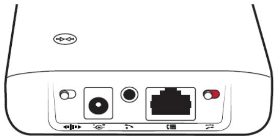
Если переключатель установлен в позицию «вкл.» (зеленый цвет), то для принятия вызова достаточно снять гарнитуру с держателя базового блока.
