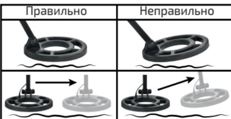
не спешите. При спешке есть большая вероятность оставить некоторые участки необследованными. Также, при быстром перемещении поисковой катушки снижается чувствительность прибора, цель может остаться необнаруженной. Держите поисковую катушку параллельно грунту, тогда прибор сможет исследовать большую площадь, глубина обнаружения также увеличится. При обследовании территории, покрытой травой, допускается касание травы катушкой.
