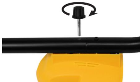
Установите подлокотник. Заверните установочный винт в отверстие на стойке.
