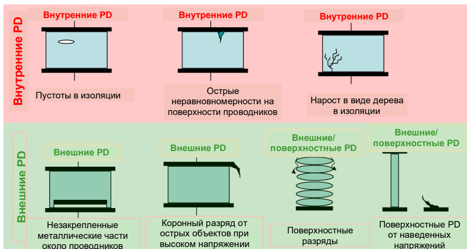
Рисунок 14: Семь основных типов активности PD (вкл. внутренние и внешние PD)
