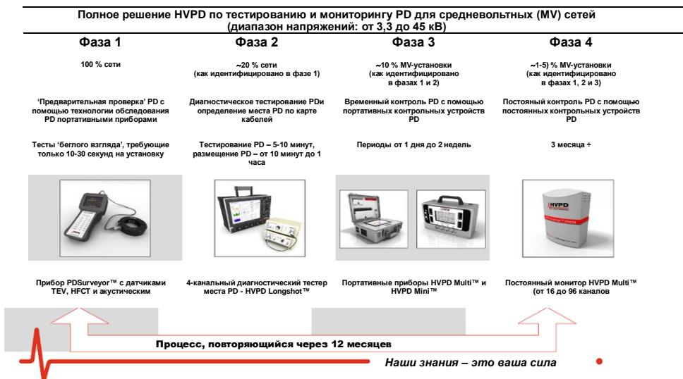
Рисунок 15: 4-фазный HVPD подход по управлению средствами к тестированию и мониторингу PD на действующих установках MV-сетей
