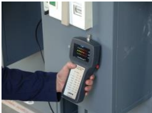
Рисунок 6: Панель 2 – Дисплей PDSurveyor™ (КРАСНЫЙ уровень 1 = 44 дБ)
