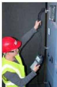
Тестирование AIS с помощью акустического поискового пробника для работы в помещении
