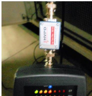
Фильтр 100 кГц, последовательно соединенный с прибором PDS Air™ - Зафиксируйте уменьшенный шумовой сигнал
