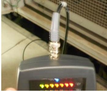
Нормальное присоединение BNC и датчика к прибору PDS Air™
