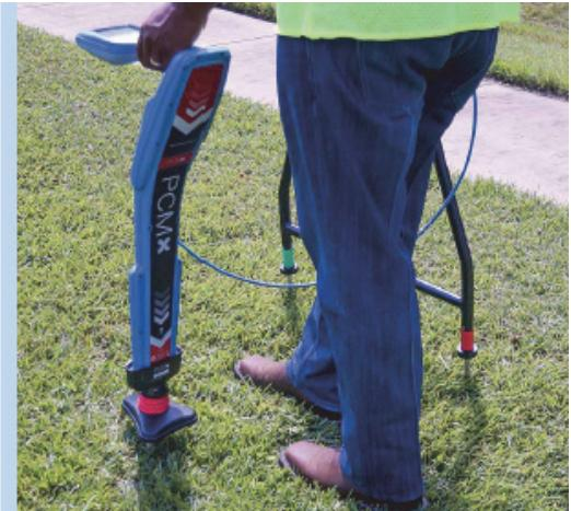
Односекундные измерения при картографировании, объединенные с одновременным получением данных по методам ACCA и ACVG, ускоряют процесс обследования.
