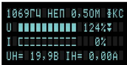
Рисунок 7.1 – режим ограничения по напряжению (▼)
