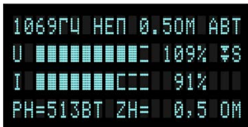
Рисунок 7.2 – режим ограничения по мощности (▼S)
