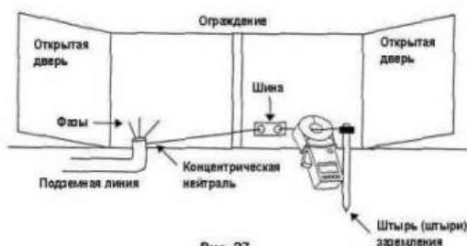
Определите и посчитайте все штыри заземления (обычно имеется единственный штырь). Если штыри заземления находятся внутри ограждения, обратитесь к рис. 27, а если за пределами ограждения – к рис.28. Если имеется единственный штырь заземления, и он находится внутри ограждения, то для измерения следует подключиться к проводнику сразу после контакта проводника со штырем. Часто, от зажима на штыре возвращается к нейтрали или внутрь ограждения несколько проводников.
