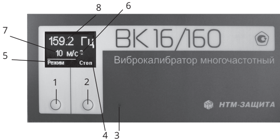
Рисунок 2. Назначение кнопок управления и содержание экрана индикатора.
