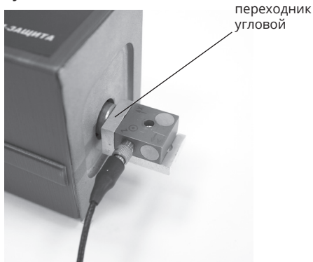
Рисунок 5. Использование переходника углового.
