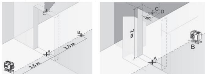
Повторите вышеописанную процедуру для второй вертикальной плоскости. Максимально допустимое отклонение высчитывается по формуле: высота проёма  $\times 2 \times 0,2$  мм/м.
