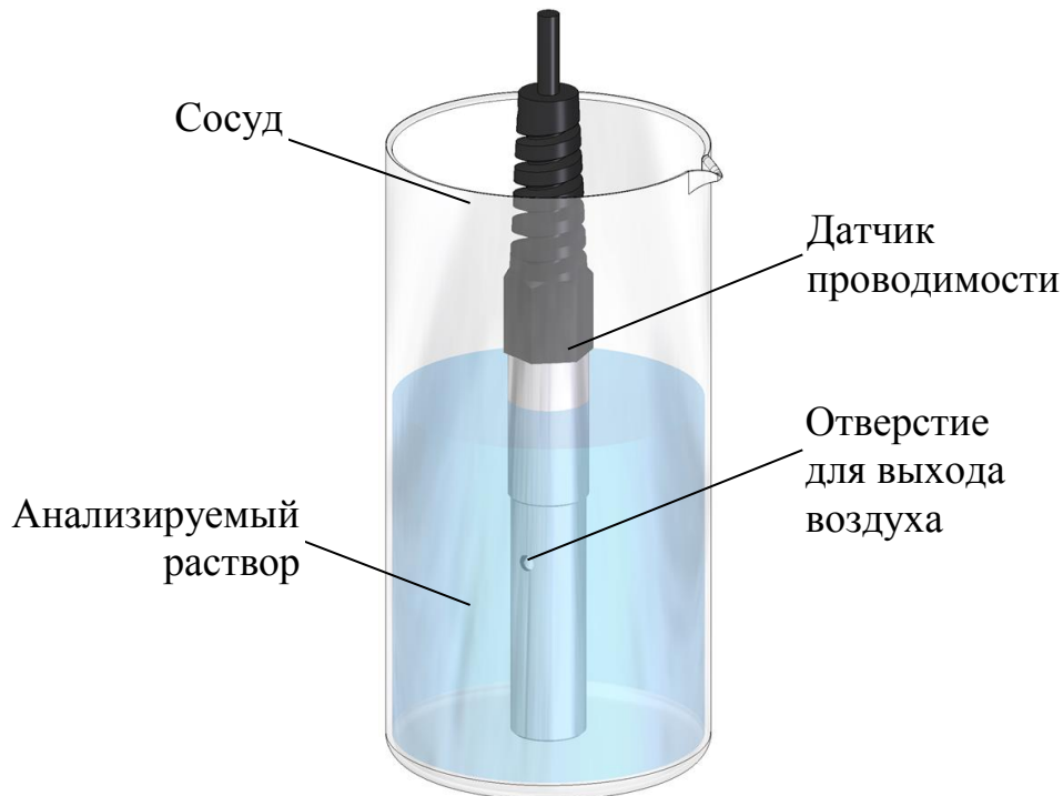
Рисунок 2.3 – Проведение измерений погружным методом
