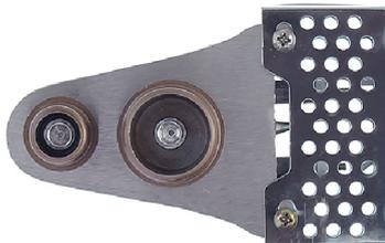
Установите аппарат на подставку, выставите нужную температуру и включите в сеть. Загорится зелёный индикатор нагрева, через 3..5 минут, когда аппарат достигнет рабочей температуры, погаснет индикатор нагрева и загорится красный индикатор готовности – можно приступать к сварке. Время нагрева аппарата зависит от температуры и движения воздуха в помещении, где проводится сварка.
