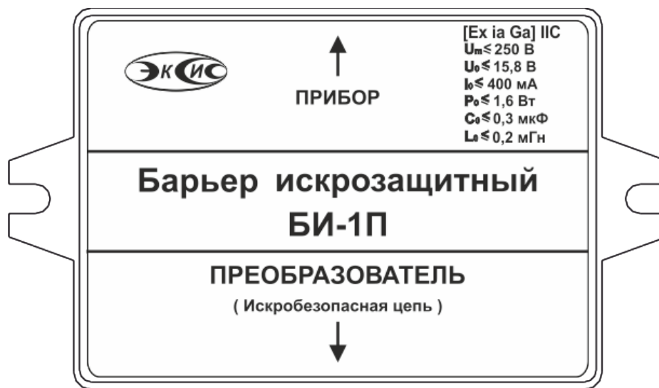
Рисунок 3.18 Барьер искрозащиты БИ-1П
