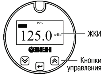
Рисунок 4.4 – Лицевая панель нормирующего преобразователя
