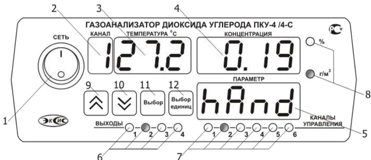
Рисунок 3.1 Вид лицевой панели прибора, сверху вниз исполнение: ПКУ-4 /1-С-4Р-2А, ПКУ-4 /2-С-4Р-2А, ПКУ-4 /4-С-4Р-2А (сверху вниз)
