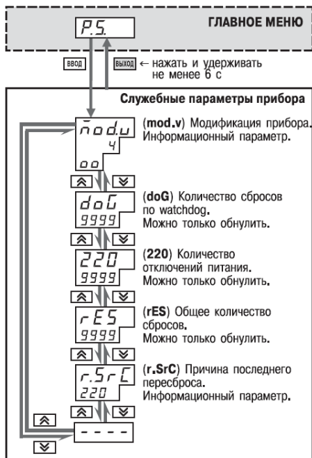
Рисунок 11.16 – Схема доступа к служебным параметрам прибора
