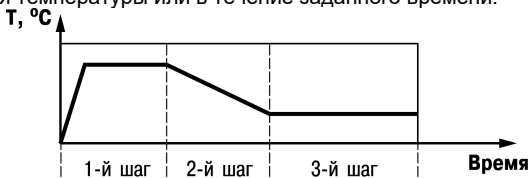
Рисунок 3.2 – Пример Программы технолога для TRM151-09
