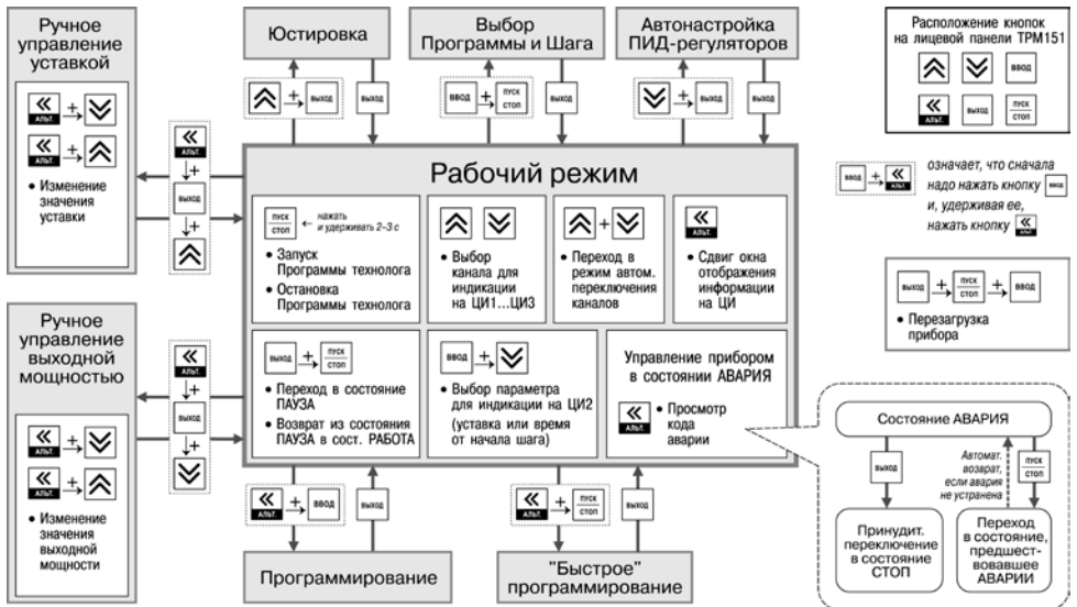
Рисунок 5.2 – Схема переключения режимов прибора
