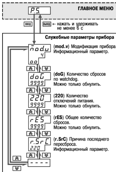
Рисунок 11.18 – Схема доступа к служебным параметрам прибора
