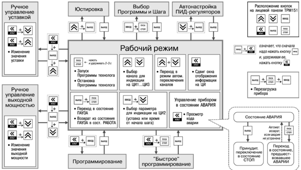
Рисунок 5.3 – Схема переключения режимов прибора
