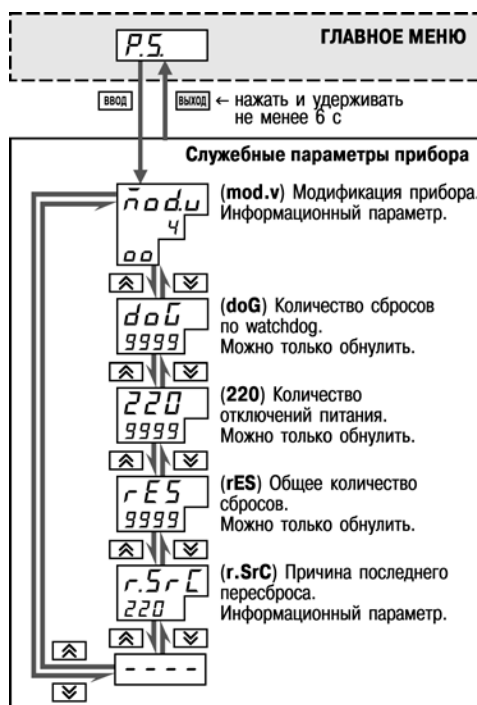
Рисунок 11.18 – Схема доступа к служебным параметрам прибора
