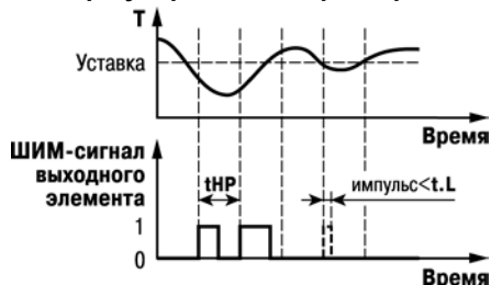
Рисунок 3.9 – Задание параметров ШИМ-сигнала
