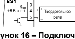
Рисунок 16 – Подключение к твердотельному реле
