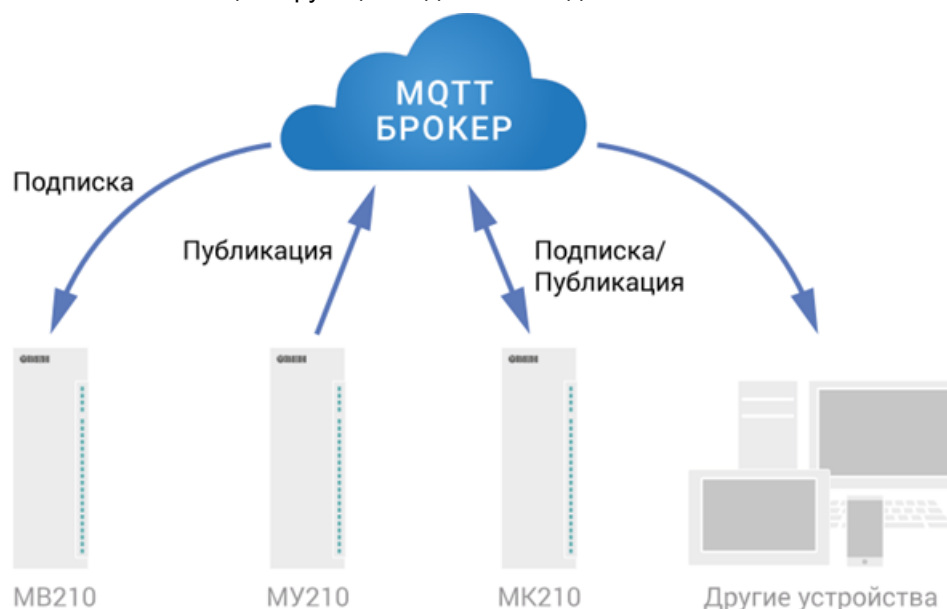
Рисунок 6.2 – Структурная схема обмена по протоколу MQTT
