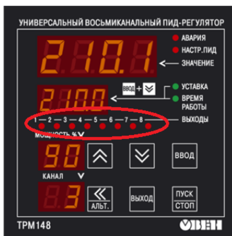
Рисунок 2.15 – Срабатывание ключевых ВУ сопровождается засветкой соответствующего светодиода
