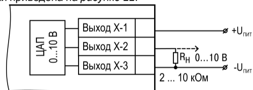
Рисунок 22 – Схема подключения нагрузки к ВУ типа У
