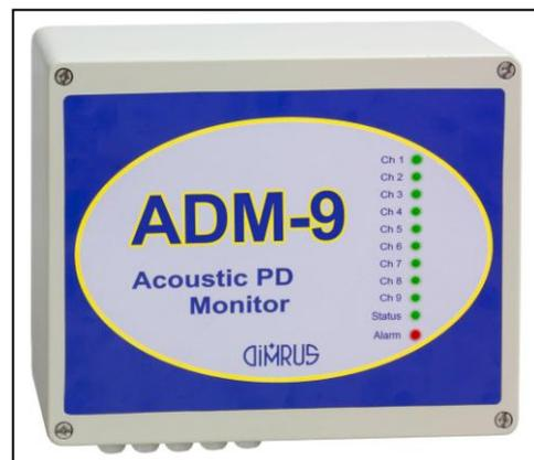
Система мониторинга «ADM-9» (Acoustic PD Monitor) предназначена для оперативного контроля технического состояния и поиска дефектов изоляции высоковольтного оборудования под рабочим напряжением. В системе «ADM-9» диагностика осуществляется на основе метода регистрации и анализа частичных разрядов, который имеет максимально высокую чувствительность при поиске дефектов в изоляции любого типа.
