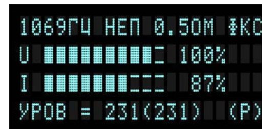
Рисунок 10 – Стабилизация по мощности
