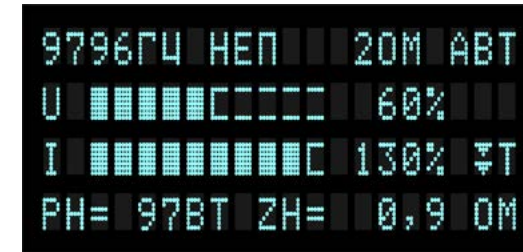
Рисунок 6.4 – режим ограничения по температуре (▼T)
