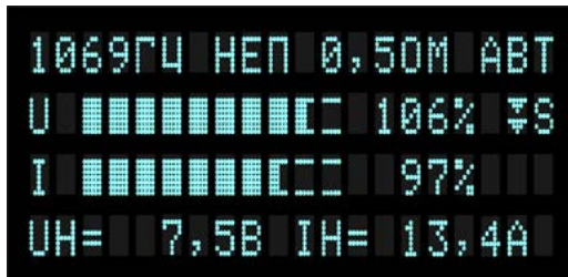
Рисунок 6.2 – режим ограничения по мощности (▼S)
