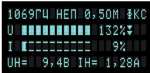
Рисунок 6.1 – режим ограничения по напряжению (▼)
