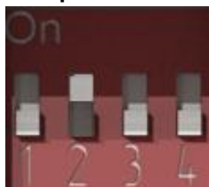
Рисунок 6.4 – DIP-переключатель. Джампер 2 в положении ON
