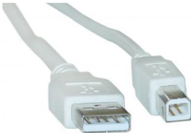
Рисунок 6.2 – Внешний вид кабеля USB A – B
