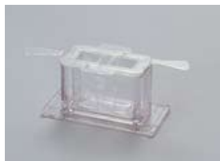
Маленькая чашка для образцов (10мл). Используется при измерении небольшого количества образца.
