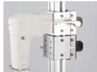
Дополнительный фиксатор. Используется для фиксации высоты сенсоров при повторных измерениях.
