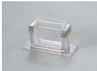
Стеклянная чашка для образцов (13 мл). Используется при измерении таких веществ, как растворители и т.п. образцы.
