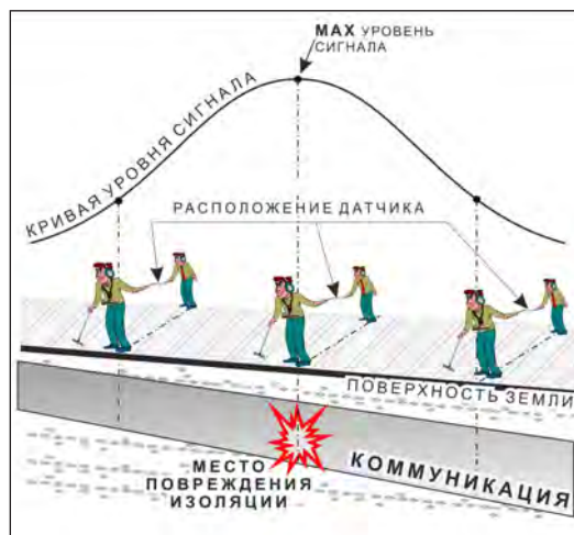
применение датчика-определителя дефектов коммуникации (ДОДК) методом min
