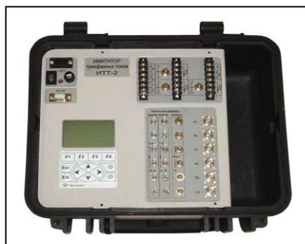
При помощи имитатора «ИТТ-2» производится проверка и калибровка приборов защиты и мониторинга вводов в условиях производства. Наличие дополнительных тестовых каналов и возможность управления выходными сигналами имитатора с компьютера в значительной мере расширяют его возможности.
