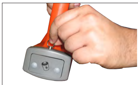
а) Выдвинуть фиксатор и освободить батарейный отсек
