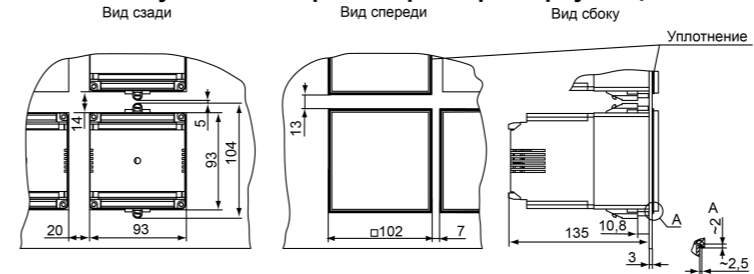
Рисунок 3 – Прибор в корпусе Щ4, установленный в щит толщиной 3 мм
