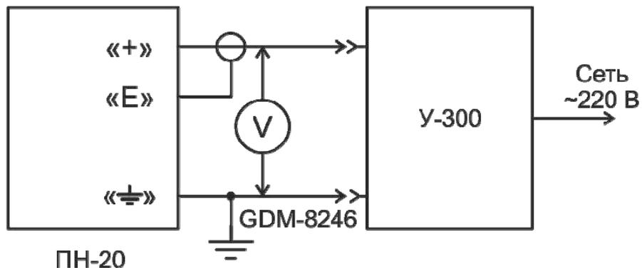
Рисунок 13 - Измерение напряжения переменного тока
