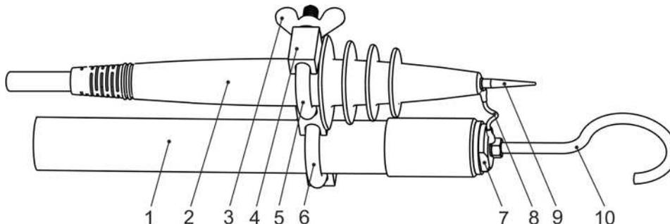
Рисунок 6- крепление щупа измерительного кабеля к штанге оперативной, где:
