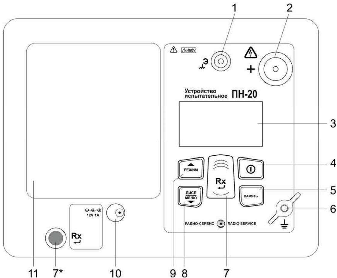
Рисунок 2 - Расположение разъемов подключения и органов управления устройства
