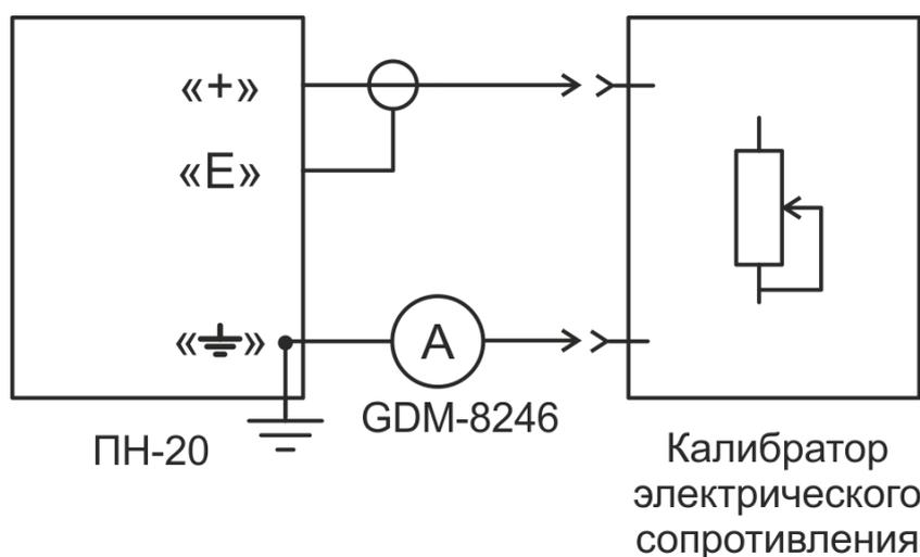
Рисунок 12 – Измерение сопротивления изоляции и силы тока
