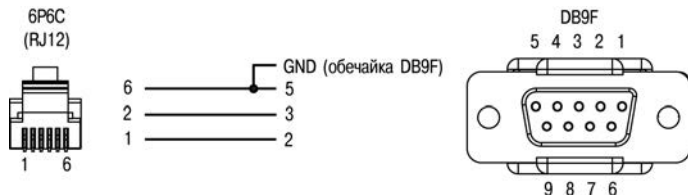
Рисунок В.5 – Кабель KC2 для подключения ПЛК150 к панелям ИП320, СП270 и СП3хх (порт RS-232 Debug)
