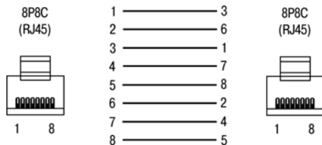
Рисунок В.7 – Кабель Ethernet crossover
