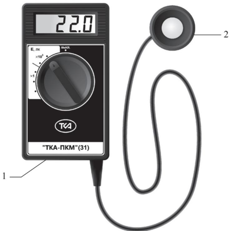
Рис.1 – Внешний вид прибора “TKA-ПКМ”(31)
