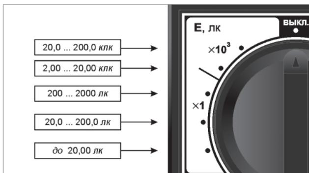
Рис.2 – Поддиапазоны измерения освещенности
