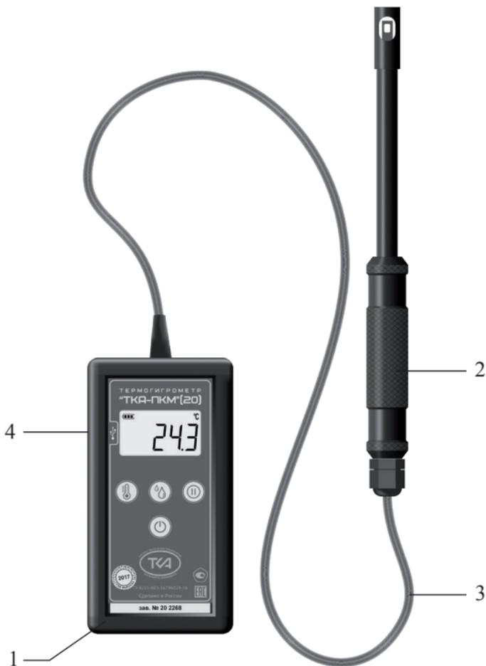
Рис.1 – Внешний вид прибора “ТКА-ПКМ”(20)
