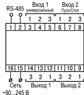
Рисунок 5.2 – Общая схема подключения TPM101
