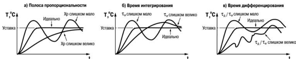
Рисунок Г.3 – Примеры графиков переходной функции
