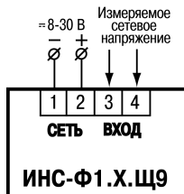
Рисунок 7 – Назначение клеммника прибора модификации Ш9
