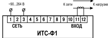
Рисунок 5.3 – Схема подключения с трансформатором
